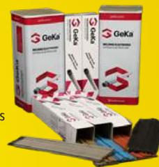
Electrode enrobée rutile pour utilisation universelle sur des aciers non alliés positions de soudage : toutes, même verticale descendante polarité : DC (-) AC l'étui de 1kilo est en plastique transparent. Classification AWS A5.1 : E 6013 // EN ISO 2560-A : E 42 0 RC 11
