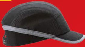
Coque de protection en ABS, mousse de protection en EVA, toile extérieure en tissu 85% coton 15% polyester mesh, coque de protection articulée, visière de 5cm et 3cm, réglage par velcro de 54 à 59 cm
