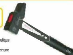
tête en acier à forte teneur en carbone C45E emmanchement réalisé par une machine hydraulique (performance à l'arrachement élevée) manche composite Carbon quadri-matière, avec une âme incassable en fibre de verre.
